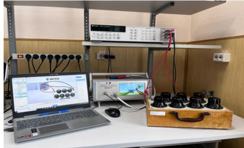
Полуавтоматическая поверка магазина сопротивлений МСР-63
