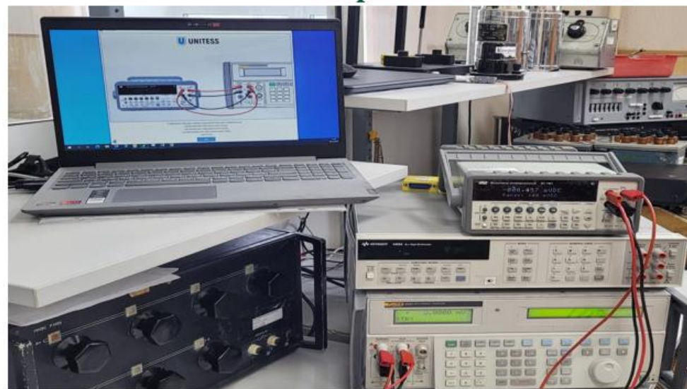
Автоматизированная поверка вольтметра универсального В7-78/1
