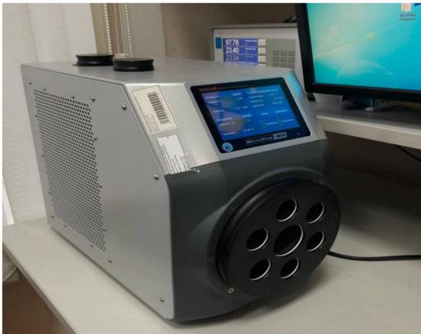
Генератор влажного газа Humiwell в комплекте с гигрометром MBW 473-RP2 Dew Point Mirror
